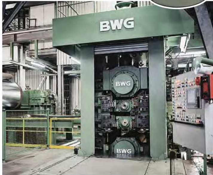
Laminador quadro numa linha de zincagem a fogo
