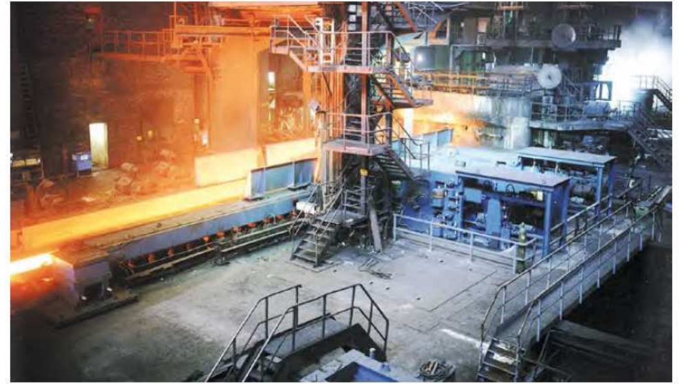
Guia de entrada e transportador de roletes quente com laminador pesado de uma linha de laminação larga quente
