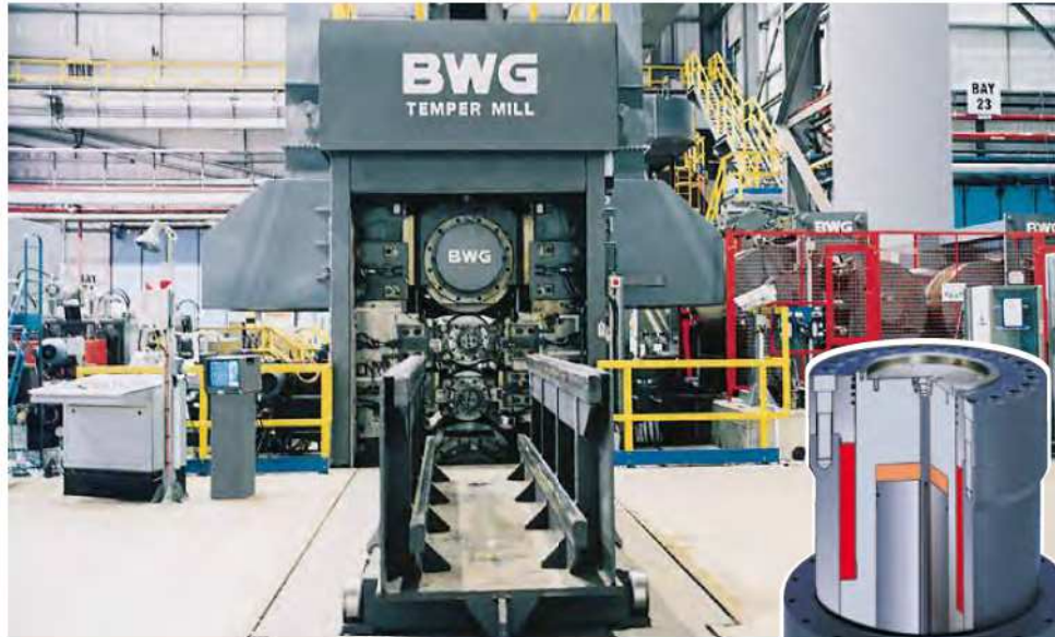
Laminador quadro de t mpera numa linha de recozimento cont nuo
