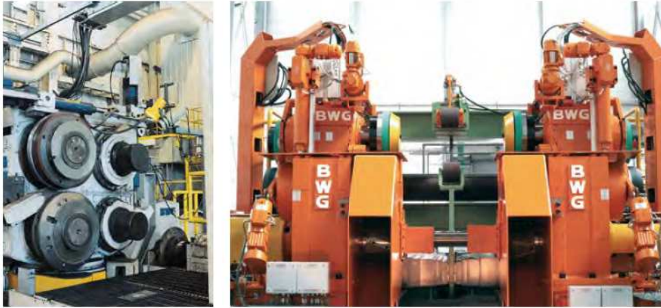
Tesoura de refilê BWG com sistema de acompanhamento do desvio lateral da fita em uma linha de recozimento e decapagem para fita de aço inoxidável
