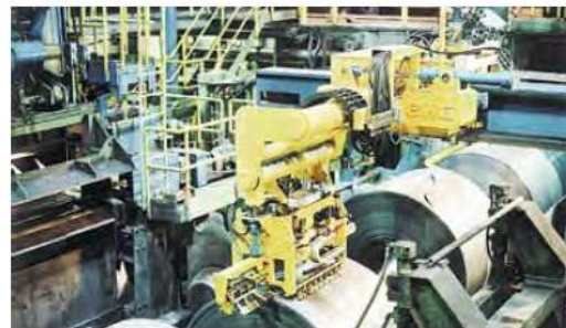
Instalação para tirar a fita da bobina
