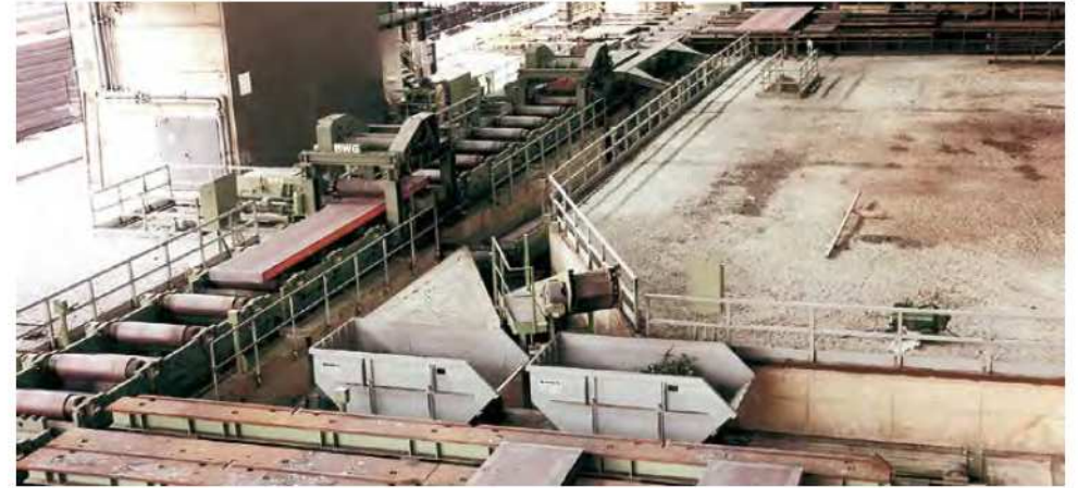
Linha de rebarbamento de corte a quente transversal e longitudinal
